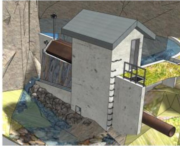
Vue sur les barreaux de descente vers l'aval de la prise d'eau – Alp Études
